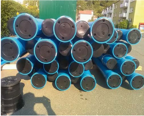
Abb. 4 - Neues Leitungsmaterial, Duktiles Gussrohr, kurz GGG
